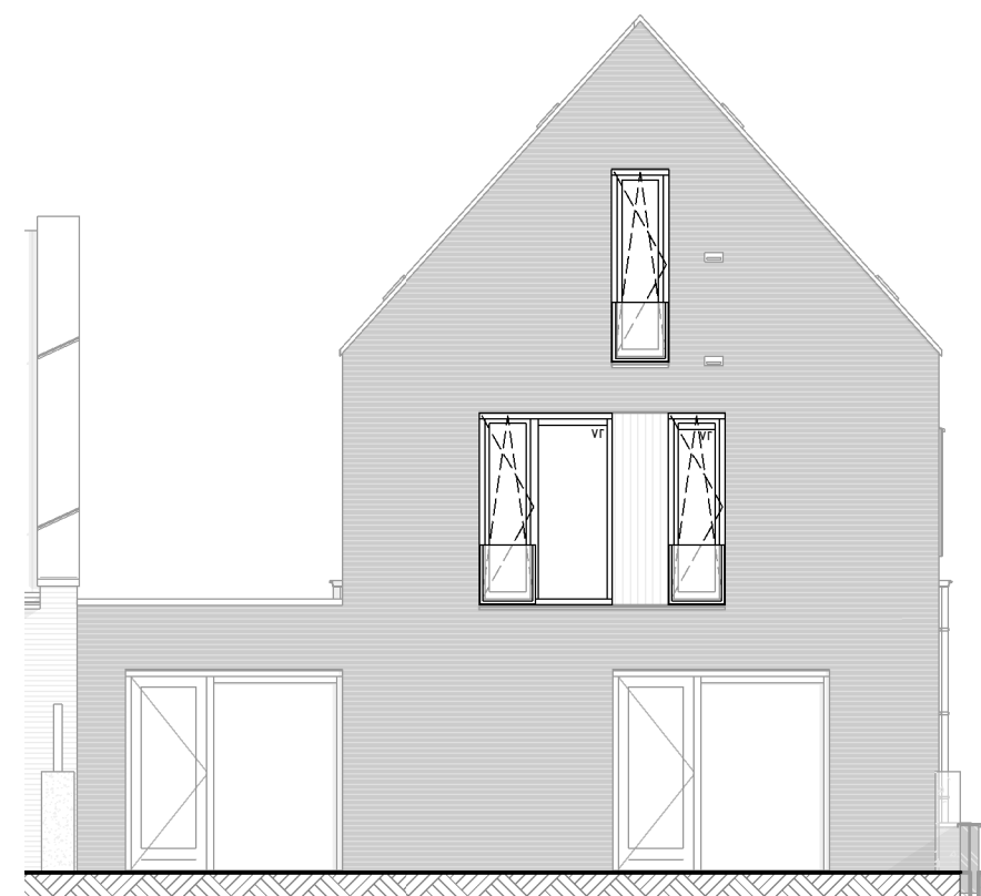
Achtergevel optie draaikiepraam icm Frans balkon
