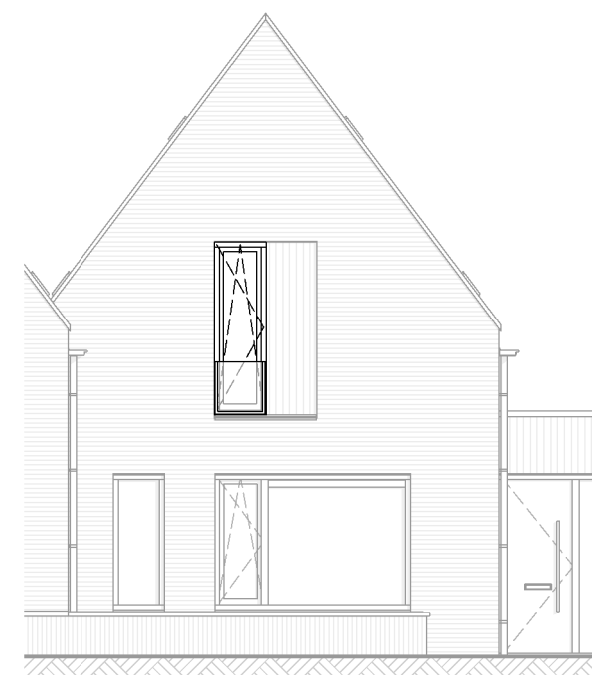
Voorgevel optie draaikiepraam icm Frans balkon
