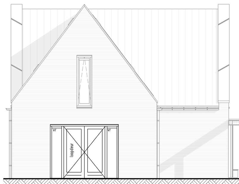
Linkergevel dubbel openslaande deuren
