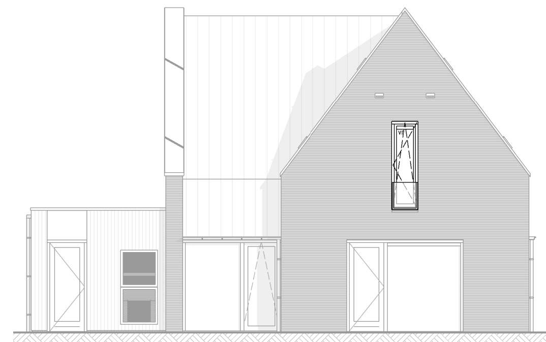
Achtergevel optie draaikiepraam icm Frans balkon
