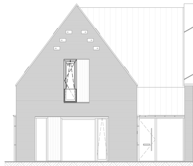
Vorgevel optie draaikiepraam icm Frans balkon
