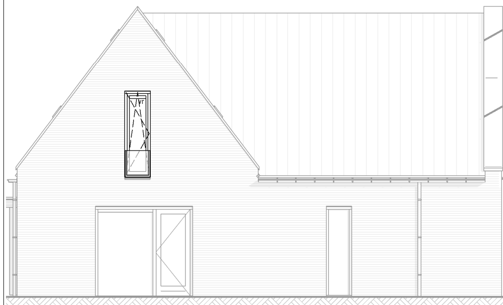
Achtergevel optie draaikiepraam icm Frans balkon
